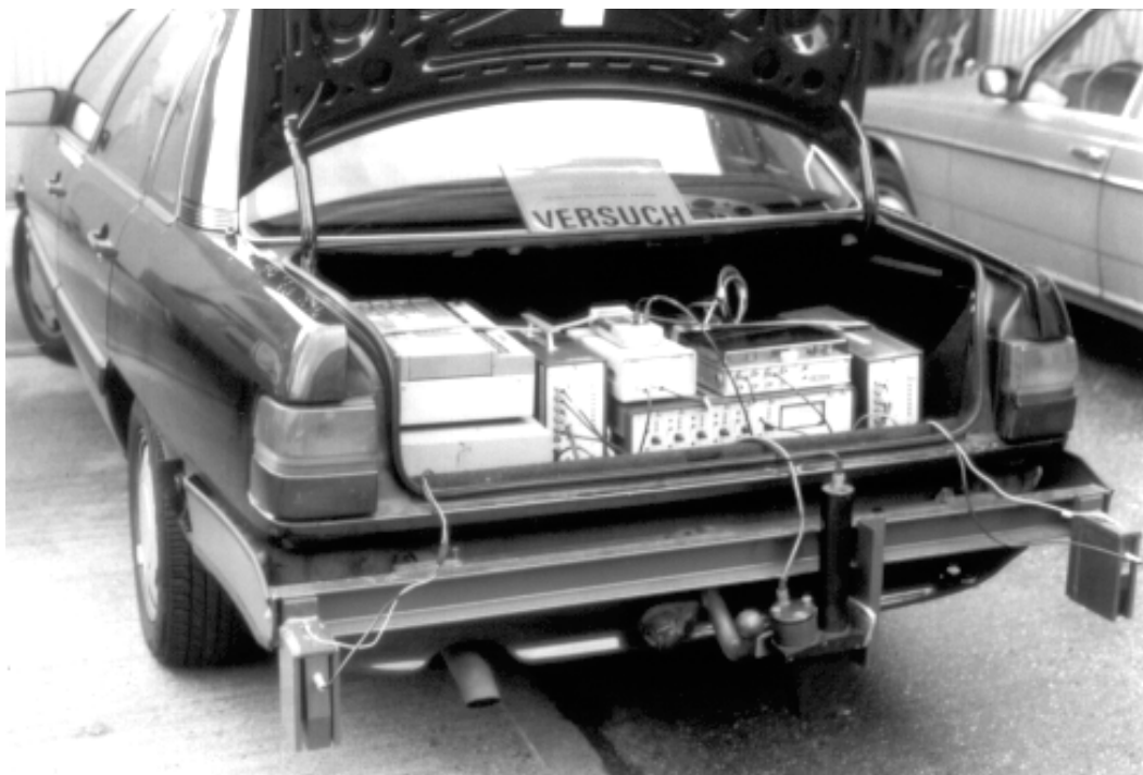
Bild 1.2-6: Meßausrüstung für Unebenheitsmessungen (ika)
