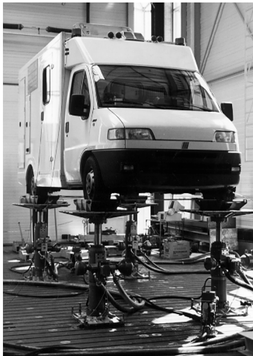
Bild 1.7-5: 4-Stempel-Hydropulsanlage des ika
